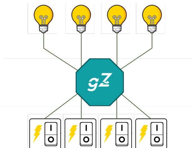
Die internetbasierte Klemme, mit 4 Kanälen, ermöglicht das unabhängige schalten von 4 elektrischen Lasten (AC 230 V / 5 A). Sie wird in einer Gerätedose nach DIN 49073 (tiefe Dose) hinter einem UP-Einsatz oder in einer Deckendose montiert. Der Klemme können mehrere "Dienste/Anwendungen/Use Cases" hinterlegt werden.
